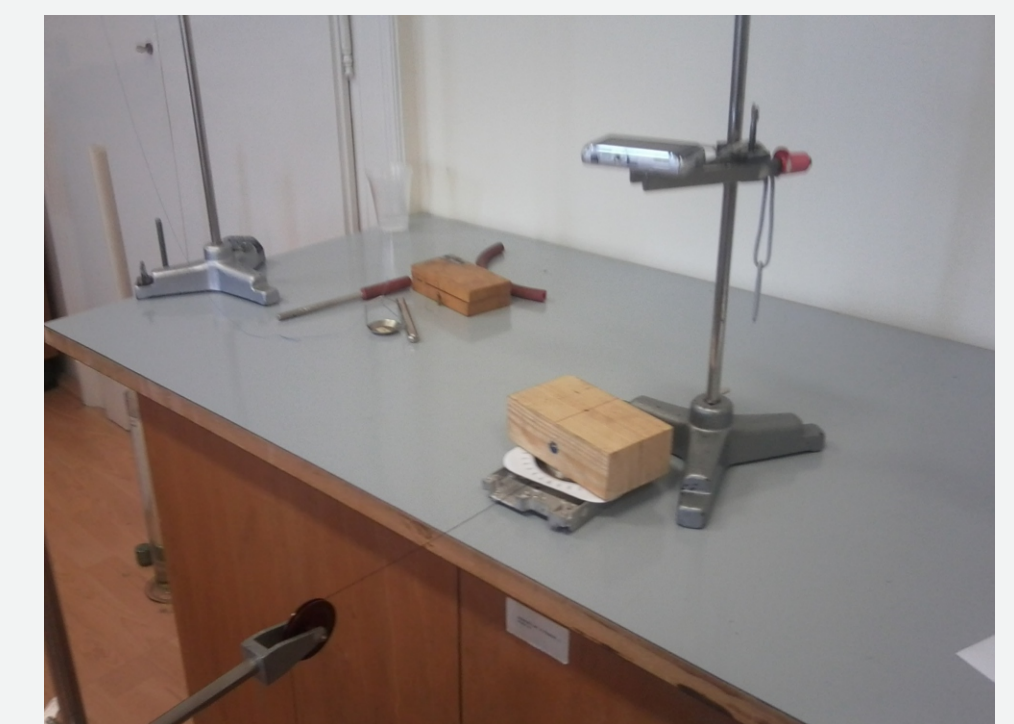
Slika 1 Postav uređaja za mjerenje kuta i vremena.
